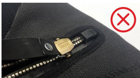
Sonneneinstrahlung. Lagern Sie den Reißverschluss **VOLLSTÄNDIG GEÖFFNET** und vermeiden Sie es ihn stark zu biegen. Die Lagerung des Reißverschlusses in einer geschlossenen Position über einen längeren Zeitraum wird zur Deformierung der Dichtflächen führen. Die Lagerungen in teilgeöffnetem Zustand verursacht eine Biegung des Reißverschlusses und kann zu geringfügigen Undichtigkeiten führen. Stellen Sie keine schweren Gegenstände auf den Reißverschluss.
